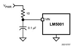
**FIGURE 2. Input Transient Protection**
